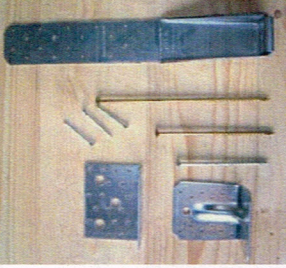
左下写真の7階建ての振動台実験の建物で使われた接合金物とスクリューの種類は右の写真です。 6
